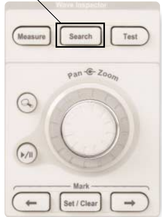
▶ 그림 3A. Wave Inspector의 강력한 검색 기능을 이용하면 사용자가 지정한 이벤트가 획득된 데이터에서 발생할 때마다 이를 발견할 수 있습니다.
