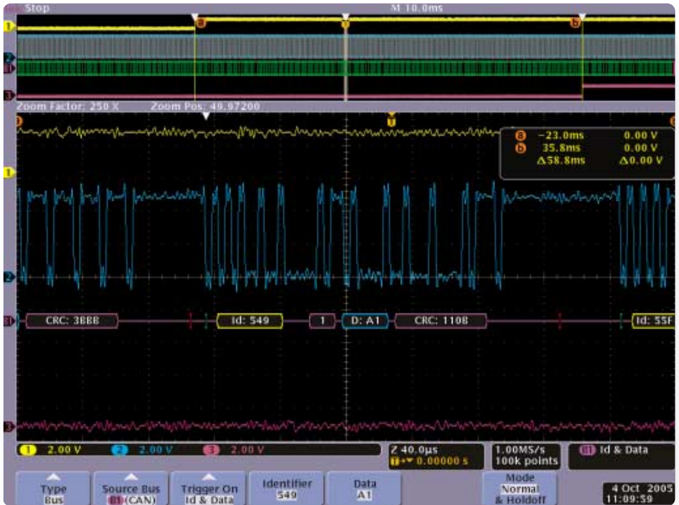
▶ 그림 3. CANbus에서 지연 시간 계측에 도움이 되도록 파형에 표시
